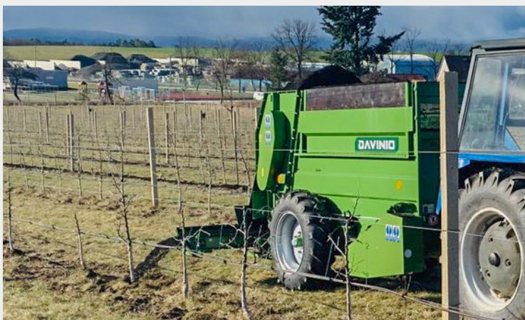
Příčný pásový dopravník pro přesné hnojení např. do sadů
