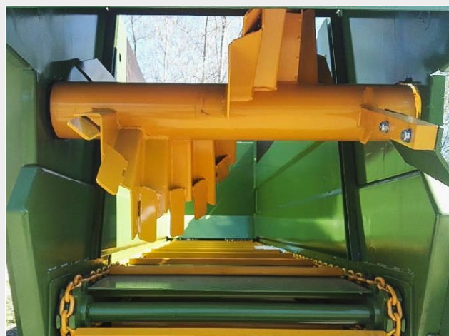
Horizontální rozmetací ústrojí se záběrem 1,5 m
