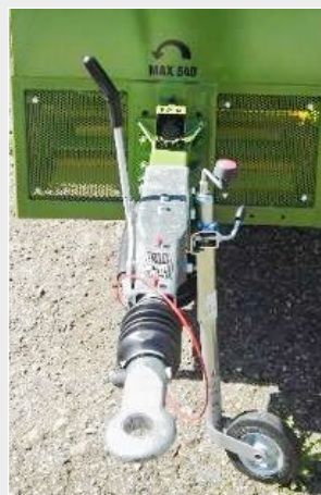
Horní závěs s provozní nájezdovou a ruční mechanickou brzdou
