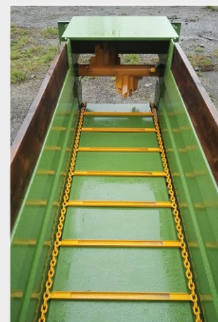
Řetězový podlahový dopravník posouvá materiál k rozmetacímu ústrojí
